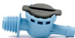
VÁLVULAS ANTIGOTEÓ BAJA Y ALTA PRESIÓN Válvula de baja presión ideal para utilizarse con Rondo, Rondo Mist y Tornado. Presión de cierre: 6m Presión de apertura: 20m Válvula de alta presión ideal para utilizarse con Rondo Mister y FLF. Presión de cierre: 14m Presión de apertura: 35m
