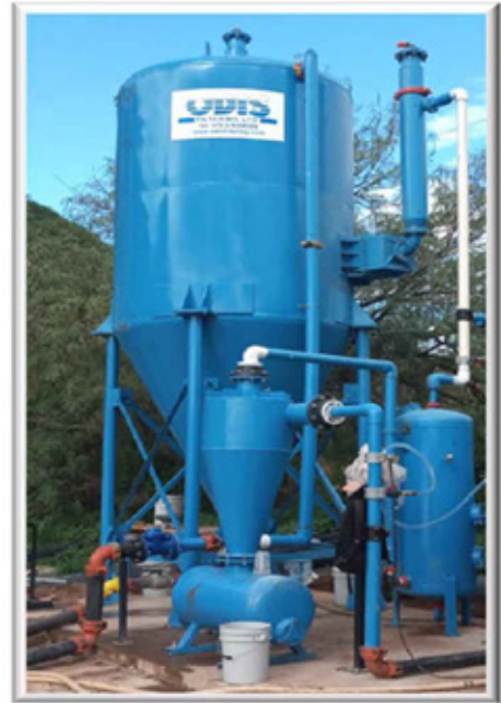
Sistema para eliminación de sólidos y clarificación del agua, procedente de mina subterránea Capacidad 900 m 3 /h
