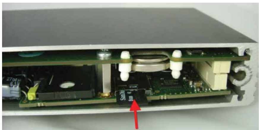
Imagen 12 Extracción de memoria micro sd
