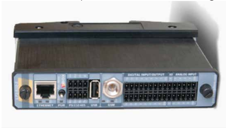
Imagen 11: Tornillos para acceso a la memoria del equipo.
